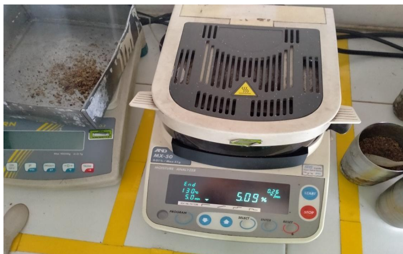
Figure 4.8. Content Moisture Using Moisture Analyzer
